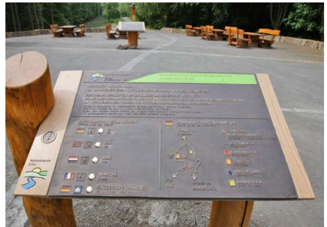
Abbildung 20: Beispiel für eine taktile Start-Infotafel am barrierefreien Wanderweg „Wilder Kermeter“ im Nationalpark Eifel, die durch weitere Tafeln ergänzt wird. Alle Tafeln sowie die Sitzgruppen sind über taktile Leitstreifen (Aufmerksamkeitsstreifen) aus Kleinsteinsplaster verbunden. (Quelle: U. Giesen)
